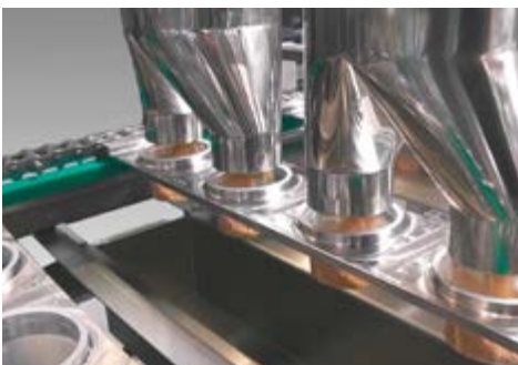
Fotos links, oben und in der Mitte: Mehrkopfwaage, aufgebaut auf einem Becherfüller GRUNWALD-ROTARY 12.000/4-bahnig zur Abfüllung von Cerealien in top caps in unterschiedlichen Mischverhältnissen Photo unten: 4-bahniger servoangetriebener Schneckenpulverfüller auf einem Längsläufer-Becherfüller GRUNWALD-FOODLINER
