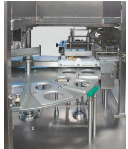
Foto oben: Blick in die vollautomatische Verschließanlage GRUNWALD-HITTPAC AKH-019RE/2-bahnig. Für eine zukünftig erweiterte Nutzung wurde ein Freiraum zum Aufbau einer Öldosierung konstruktiv eingeplant. Im Bereich der Stülpedeckelstation ist die Schutzverkleidung ausgeschachtet. Somit ist ein Nachlegen der Packstoffe ohne Maschinenstopp bequem möglich.
