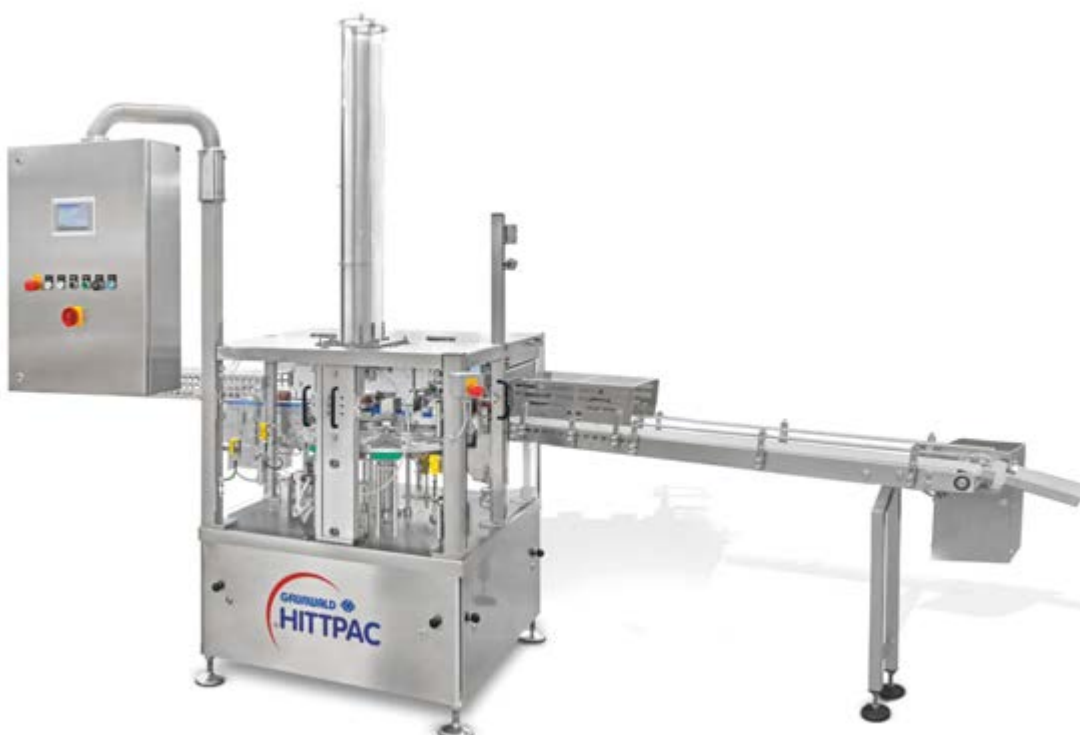
Foto oben: Blick in die vollautomatische Verschließanlage GRUNWALD-HITTPAC AKH-019RE/2-bahnig. Für eine zukünftig erweiterte Nutzung wurde ein Freiraum zum Aufbau einer Öldosierung konstruktiv eingeplant. Im Bereich der Stülpedeckelstation ist die Schutzverkleidung ausgeschachtet. Somit ist ein Nachlegen der Packstoffe ohne Maschinenstopp bequem möglich.
