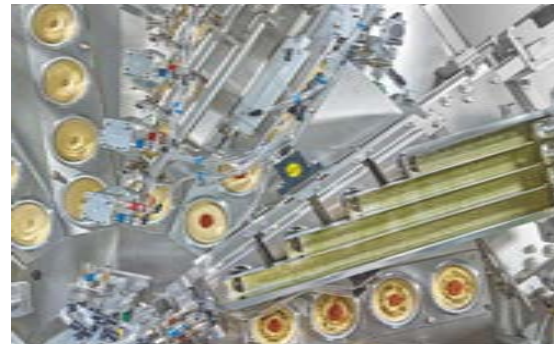
Mittige Dosierung von Dips mit Kräutergarnierung
