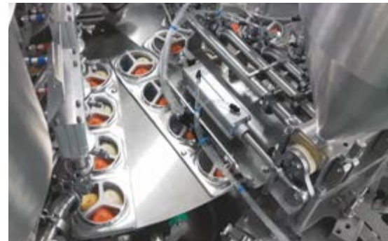
Abfüllung verschiedener Hummusprodukte in 3-Kammerbecher
