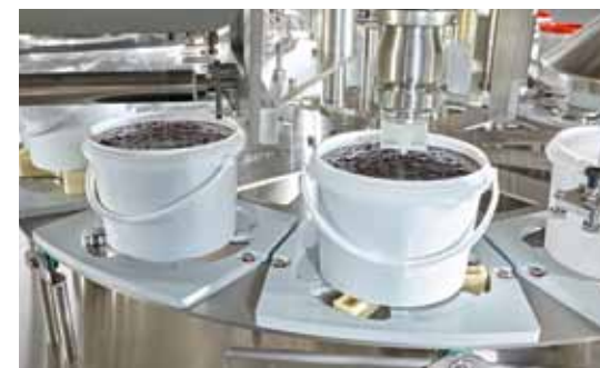
Dosierstation mit höchster Dosiergenauigkeit
