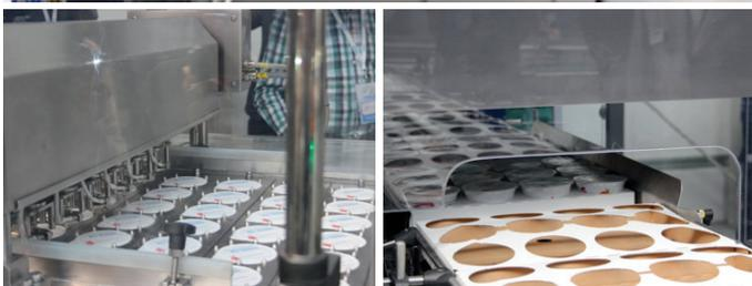
**Aseptikfüller der Serie 106KS für vorgefertigte Becher mit End-of-line-Traylösung**
