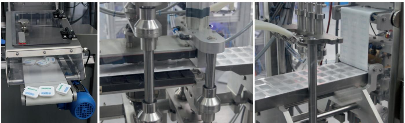
Thermoform-, Füll- und Verschleißmaschine für 25 g Portionspackungen (Serie 9000)
