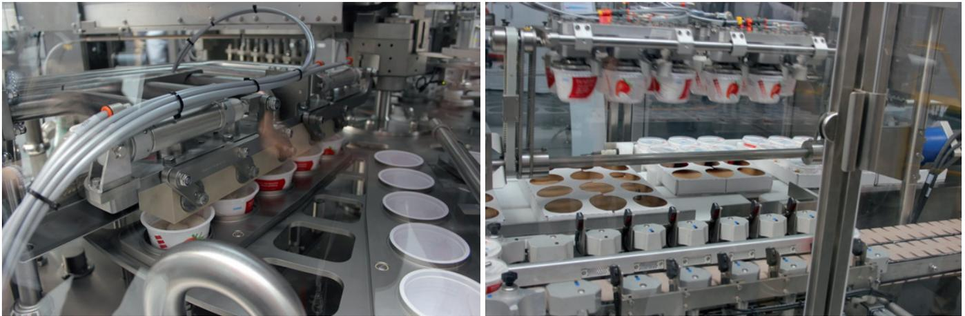
Ultraclean Rundfüller Serie 200 für Mopro; Trayaufrichter der Serie 720 und Pick & Place Station der Serie 760
