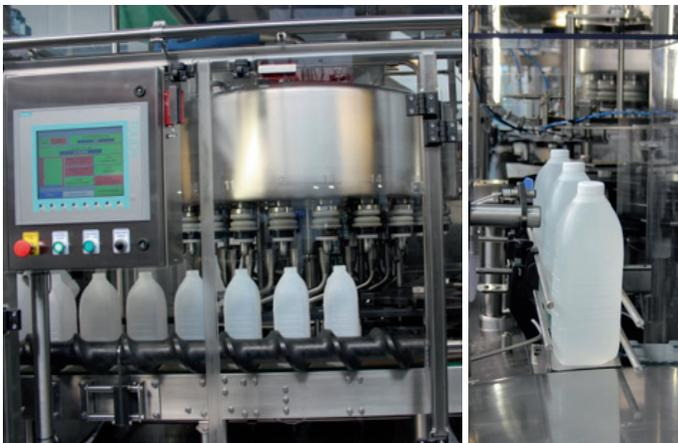
**TREPKO 3000 Hochleistungs-Rundfüller in UC-Ausführung mit Flaschenspül-, Füll- und Verschlussstationen**
