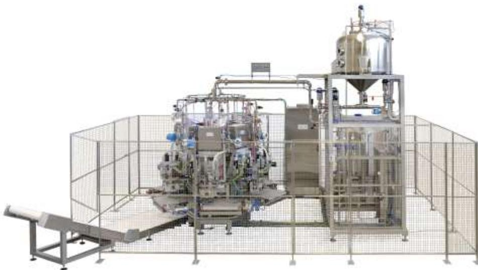
Alfa Laval hat den schnellsten aseptischen Bag-in-Box Füller im Sortiment (Foto: Alfa Laval)
