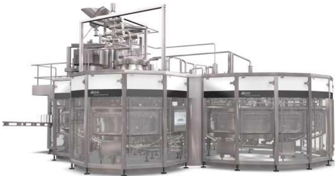
**Die erste Maschine des Typs Innosept Asbofill ASR, ein aseptischer Rundläufer mit einer Leistung bis 36.000 Fl/h, wurde nach Asien verkauft (Foto: KHS)**
